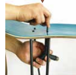
④スケボーレンチでネジを しっかり固定する。
