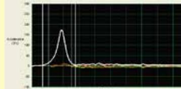
プロテクターに50ジュールの力を加え、プロテクターを通して伝達された力(加速度)を図り、(kN:キロニュートン)の数値を検証する。(室温23℃/湿度50%)数値が低いほど、衝撃吸収力が高く、より安全性が高いプロテクターと言える。
