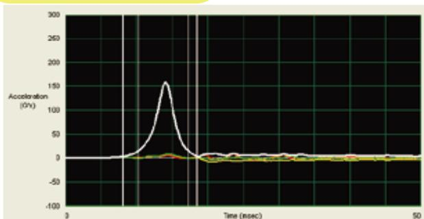
プロテクターに50ジュールの力を加え、プロテクターを通して伝達された力(加速度)を図り、(kN:キロニュートン)の数値を検証する。(室温23℃/湿度50%)数値が低いほど、衝撃吸収力が高くより安全性が高いプロテクターと言える。自社基準では、このシリーズにおいて、ボディで9kN以下がAクラス、18kN以下でBクラス、パーツで20kN以下をAクラス、35kN以下をBクラスの合格ラインとする。実験数値ではヒップセンターパッド部位値9.02kNと、18kNを下回っており弊社安全基準において、ほぼAクラスに近い数値Bでの合格といえる。
