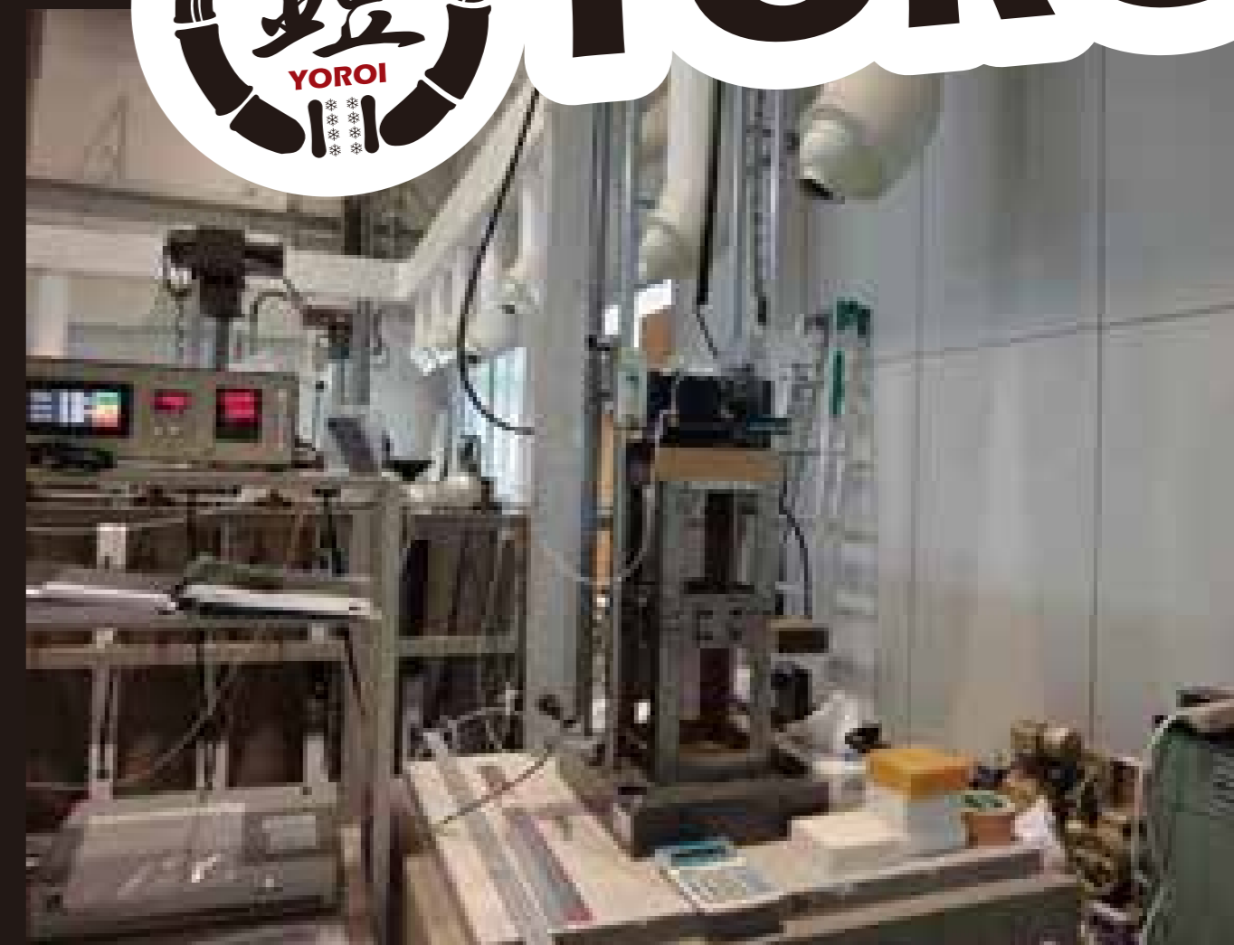
于大阪府立产业技术综合研究所进行「铠」等吸收冲击值测试的实验情景。
